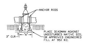
VALVE DEADMAN (ANCHOR) **ELEVATION VIEW**
